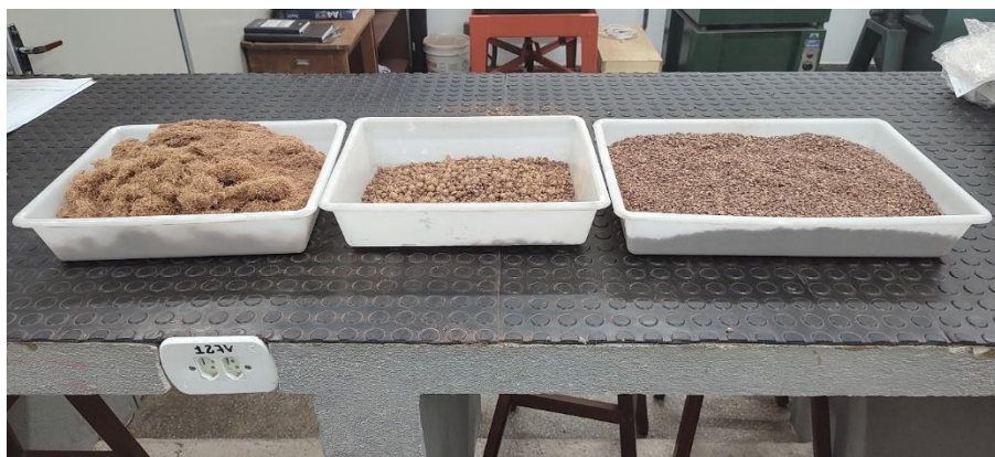
Figura 7 – Material separado no peneiramento. Fibras (esquerda), retirado do processo (meio) e material aproveitado nas etapas seguintes (direita). Fonte: autor (2023).
