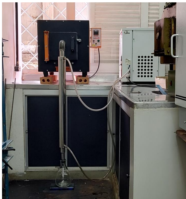
Figura 6 – Forno mufla adaptado para pirólise. Fonte: autor, 2023.
