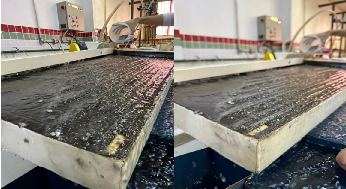
Figura 10 - Preparação e recuperação de finos em Mesa Wilfely.
