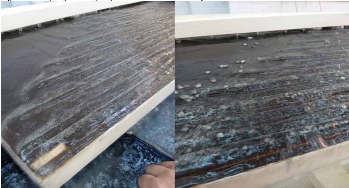
Figura 11 - Preparação e recuperação de finos em Mesa Wilfely.
