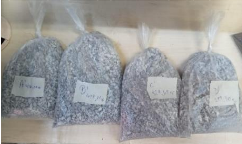
Figura 7 - Alíquotas prontas após processo de homogeneização, quarteamento e armazenamento.
