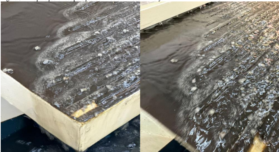
Figura 9 - Preparação e recuperação de finos em Mesa Wilfely.
