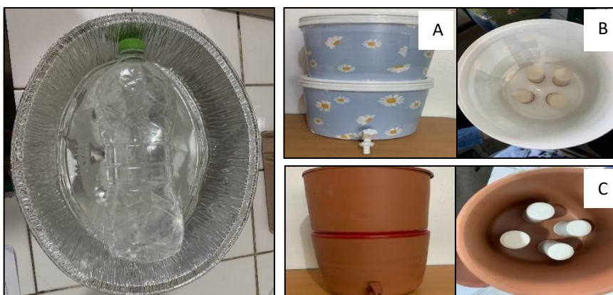
Figura 3 - Filtro de barro e recipiente para técnica de desinfecção por irradiação solar.
