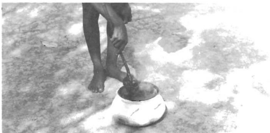
Figura 16 - Impermeabilização com resina de jutaí.
