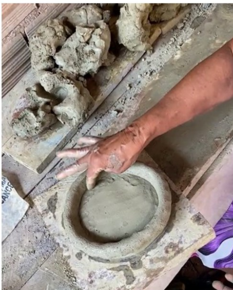
Fotografia 45 - Primeiro rolete de argila sendo fixado na base.
