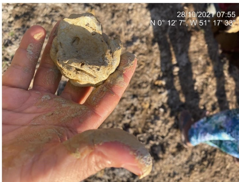
Fotografia 14 - Argila definida como ideal, após o teste de plasticidade.
