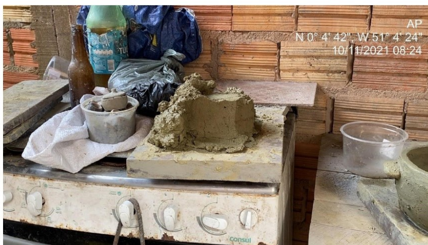
Fotografia 37 - Mistura finalizada (massa homogênea).
