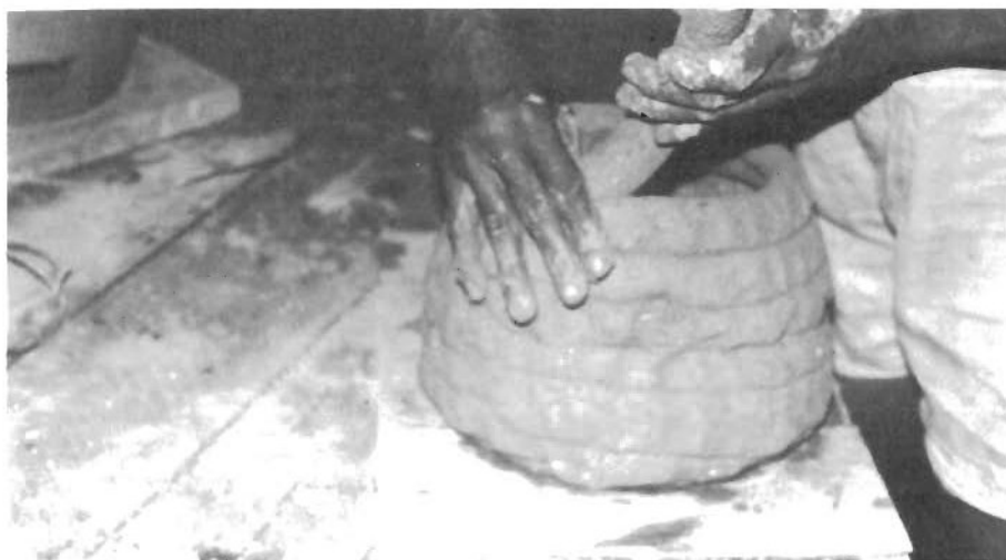
Figura 11 - Colocação do último rolete.
