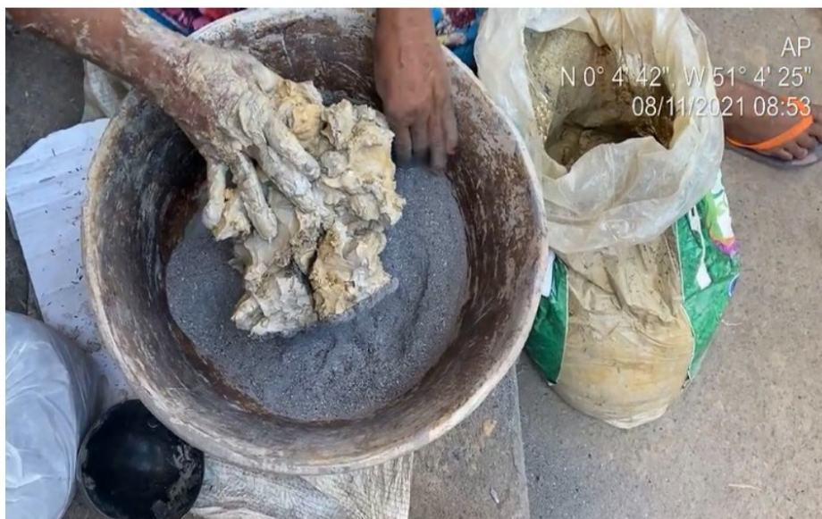
Fotografia 34 - Início da mistura da argila limpa com caripé processado.
