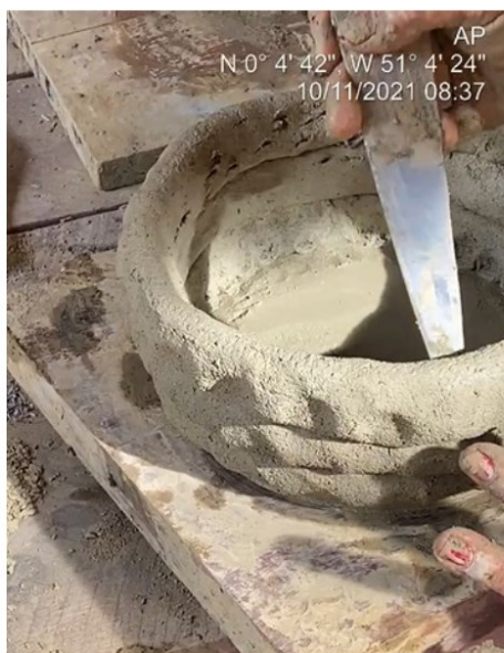
Fotografia 46 - Pequenos cortes para retirar o ar existente na argila.
