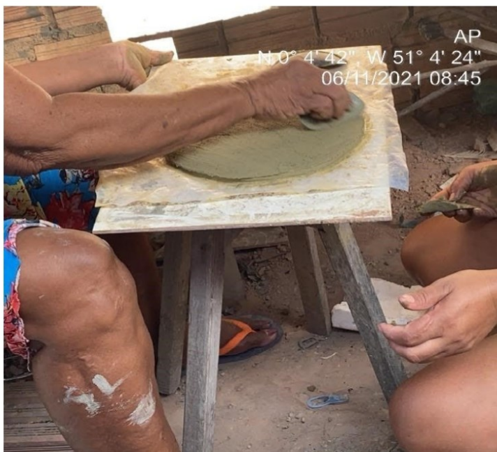
Fotografia 51 - Execução do alisamento da tampa com a cuiabeba.
