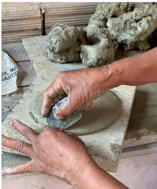
Fotografia 42 - Acabamento da base sendo realizado com a cuiapeba.
