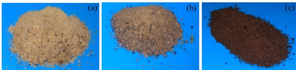
**Figura 58** - Xerogéis das composições (a) 1:3, (b) 1:1 e (c) 3:1.
