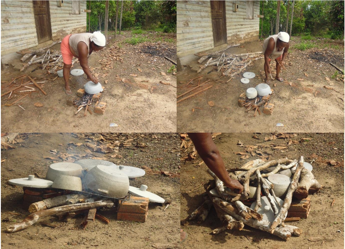
Louceira fazendo a cruz com um pedaço de carvão na peça (acima à esquerda); Louceira acomodando as peças para queima (acima à direita); Louças todas organizadas para a queima (abaixo à esquerda); Louças cobertas por pedaços de lenha (abaixo à direita).
