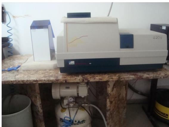
**Figura 3.9** – Granolômetro a laser (CILAS 1064).
