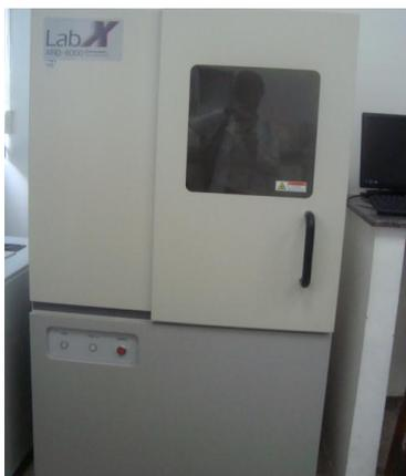
**Figura 3.8** – Difratormetro de raios x.
