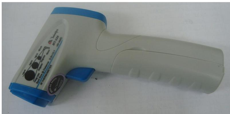
**Figura 3.16** – Termômetro de infravermelho.
