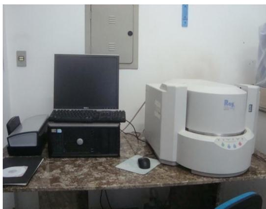
**Figura 3.7** – Espectrômetro de fluorescência de raios x.
