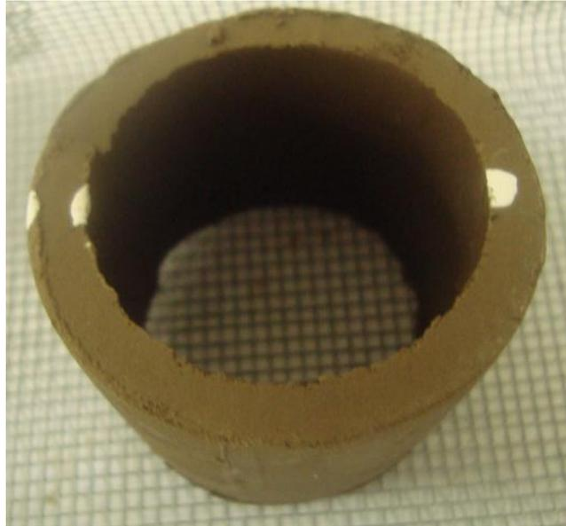
**Figura 3.20** – Cilindro vazado com pontos fixos demarcando suas dimensões.
