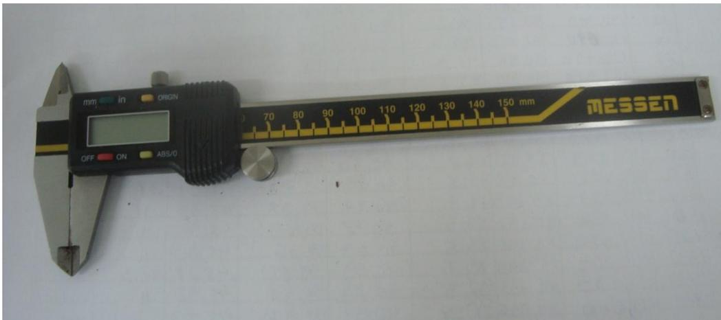
**Figura 3.14** – Paquímetro digital.
