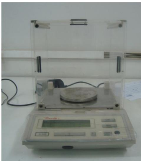
**Figura 3.15** – Balança digital.
