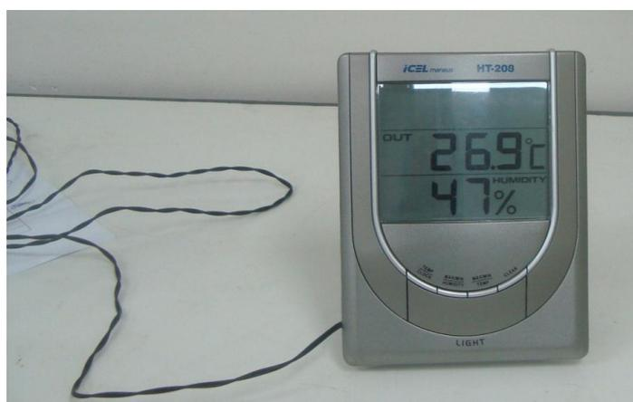
**Figura 3.17** – Termohigrômetro digital
