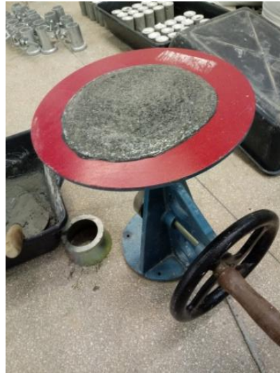
Figura 6 – Mesa para índice de consistência com argamassa após a última queda
