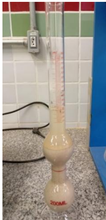
Figura 4 – Ensaio de Massa Específica da Areia pelo frasco de Chapman
