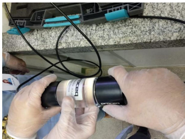
Figura 15 – Calibração dos emissores/receptores
