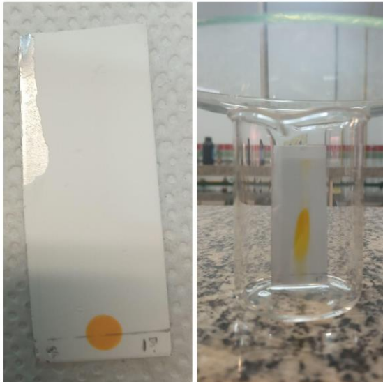
Figura 2- Fotografia de uma separação utilizando Cromatografia em Camada Delgada (CCD).
