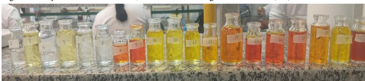
Figura 7- Frações obtidas do urucum, através da cromatografia em coluna (CC).
