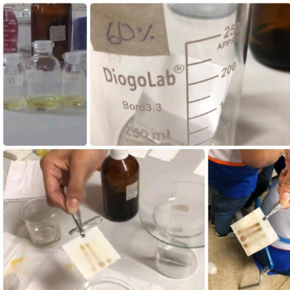
Figura 13- Separação dos pigmentos do urucum por cromatografia em camada delgada.
