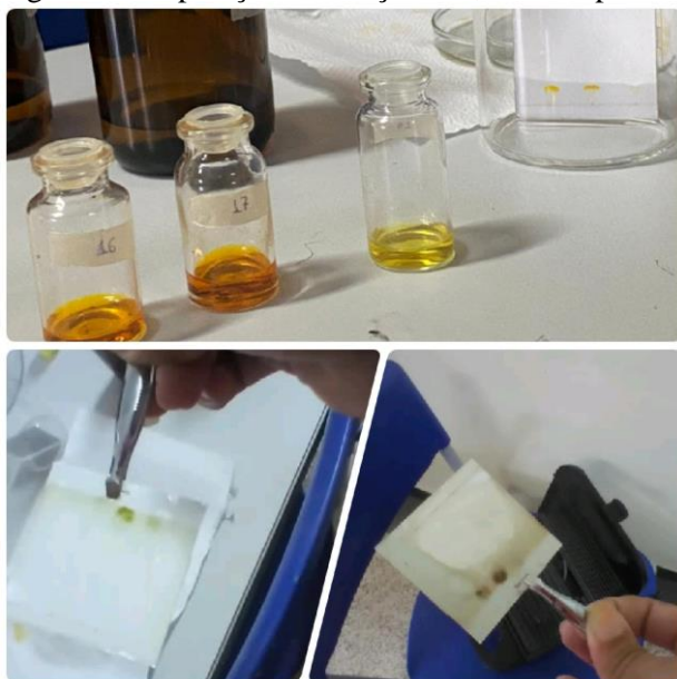
Figura 14- Separação das frações 16, 17 e 18 por cromatografia em camada delgada.
