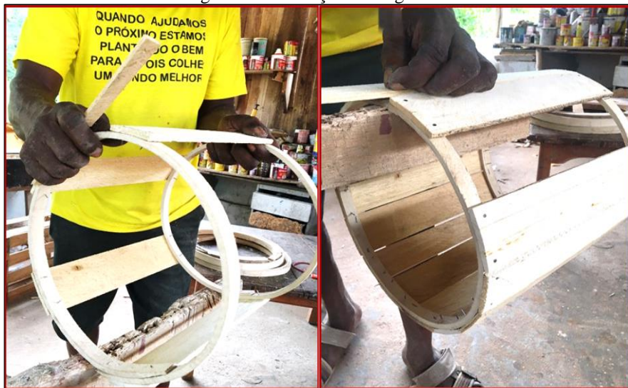
Figura 7 - Colocação das réguas no aro.
