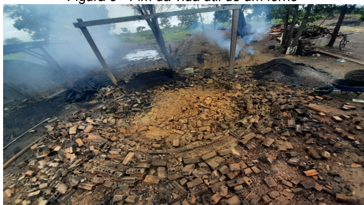
Figura 5 - Fim da vida útil de um forno
