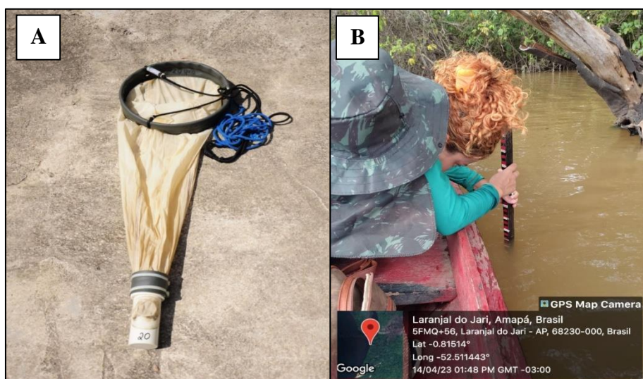
Figura 6 – Rede de captura de fitoplâncton utilizada nas coletas em campo (A); medição da variável de transparência da água através do disco de Secchi (B).
