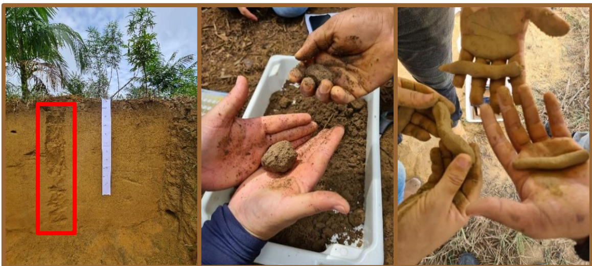
Figura 4 – Avaliação da textura do solo, em campo, utilizando o teste do Tato.
