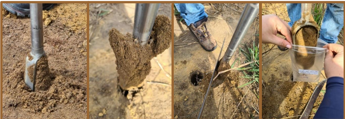
Figura 6 - Coleta das amostras de terra para caracterização química das áreas.
