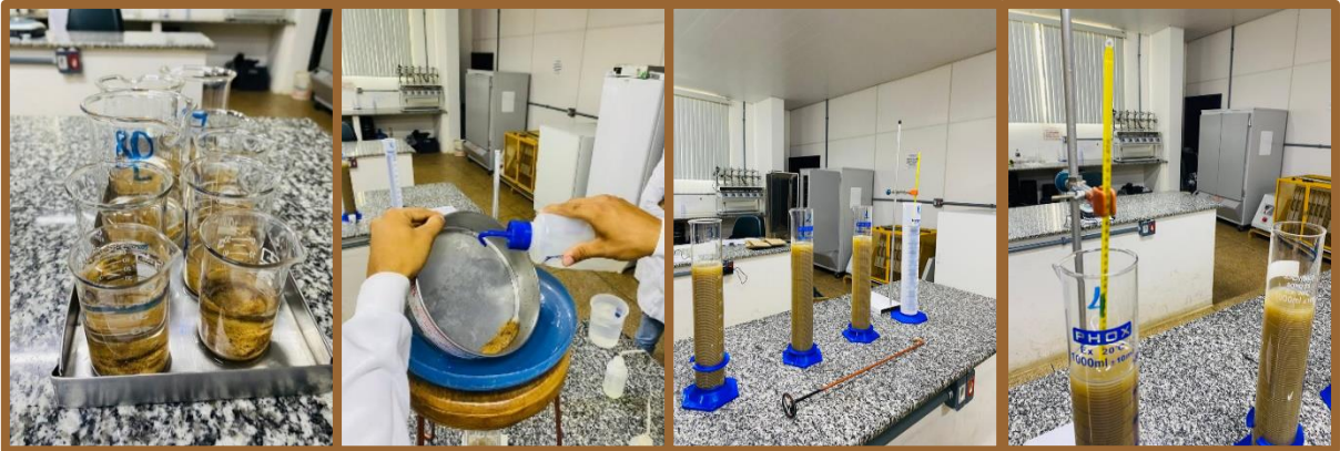
Figura 5 - Análise granulométrica do solo, em laboratório, utilizando o método da Pipeta.
