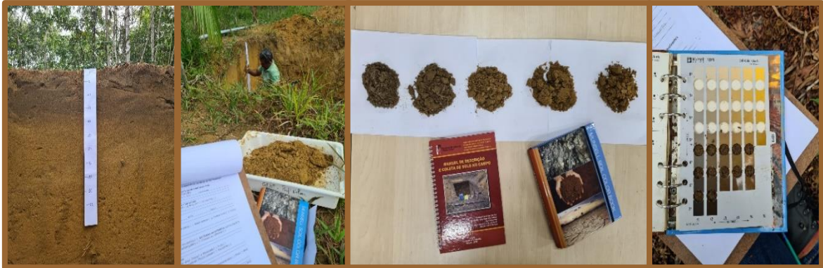
Figura 3 - Descrição morfológica e classificação dos perfis de solo.
