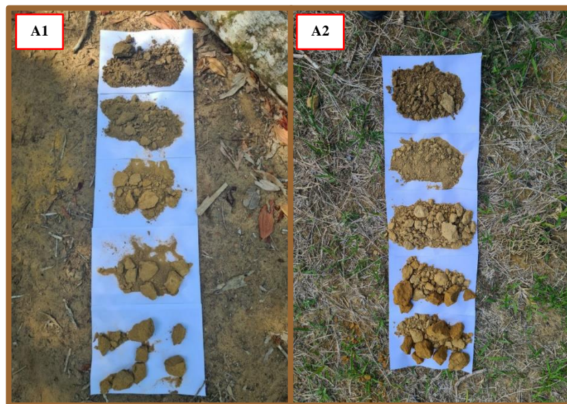
Figura 9 - Estrutura do solo das camadas dos perfis das áreas de mata (A1) e consórcio (A2).
