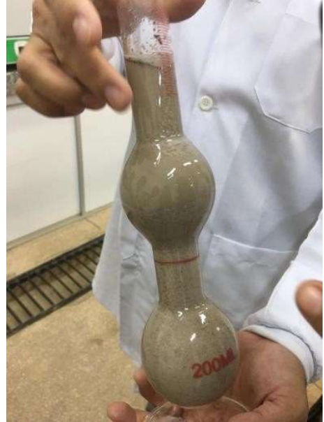
Figura 10 – Frasco de Chapman depois de agitado
