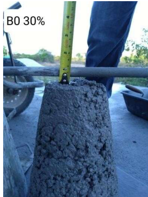
Figura 4 - Abatimento da brita 0 com adicional de 30% de RCD
