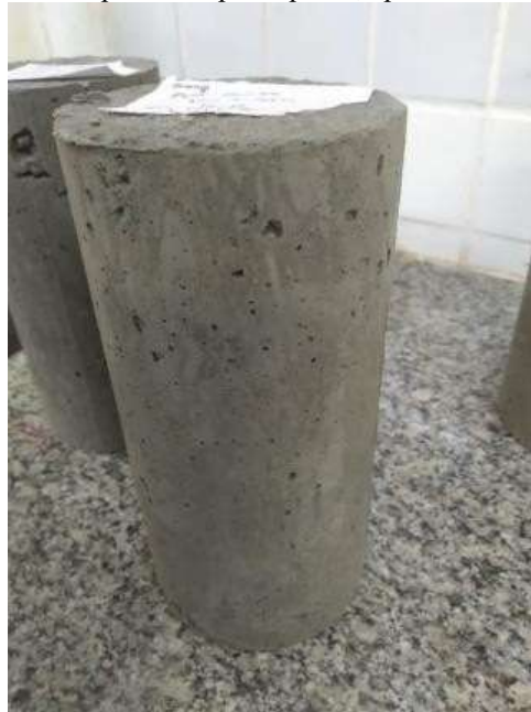
Figura 5 – Exemplo de corpo de prova, após sua desmoldagem
