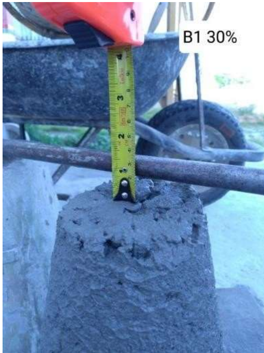
Figura 3 - Abatimento brita 1 com adicional de 30% RCD
