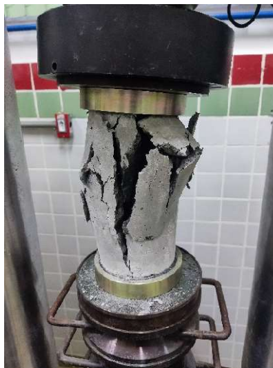
Figura 34 - CP rompido após 7 dias de cura.
