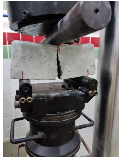
Figura 44 - Bloquete rompido após 28 dias de cura.
