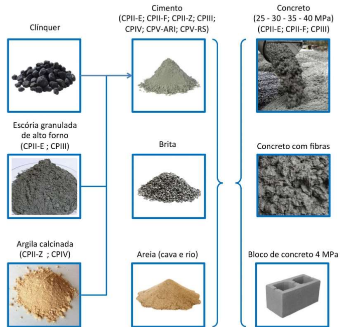
Figura 11 - Materiais necessários para a produção de concreto.
