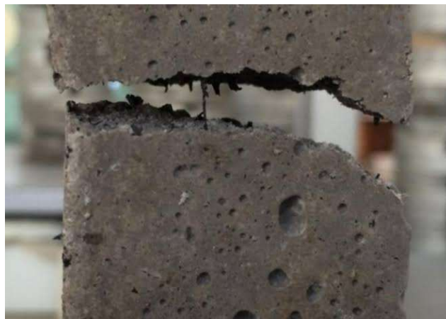
Figura 13 - Concreto com adição de fibra de borracha.
