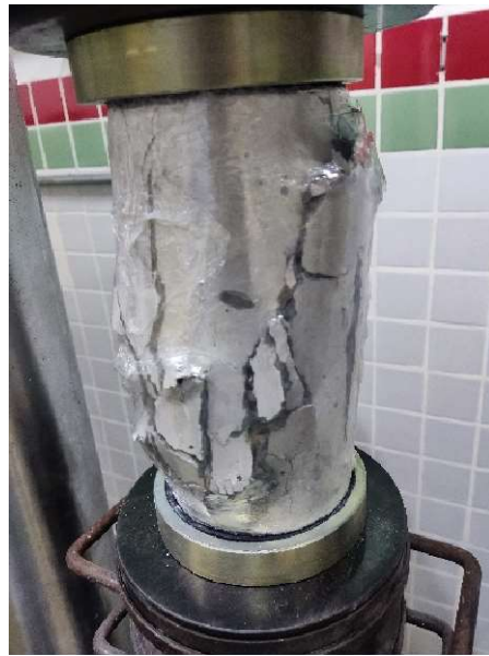
Figura 36 - CP rompido após 14 dias de cura.
