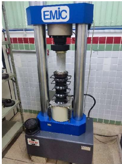
Figura 33 - CP a ser rompido na máquina EMIC.
