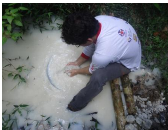
Figura 1. Processo de bateamento do minério de columbita-tantalita.
