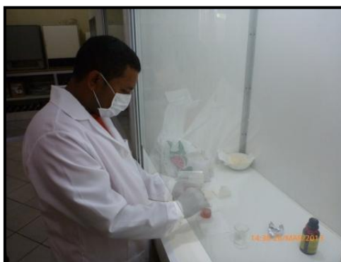
Figura 3. Separação em líquido denso nas amostras 01 e 02 estudadas.
