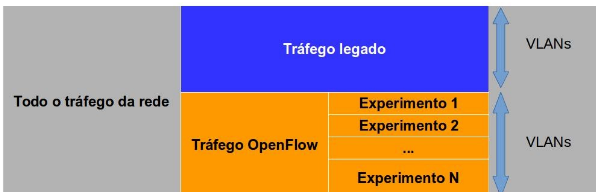
Figura 2 – Modelo de operação híbrido para tráfegos padrão e openflow
