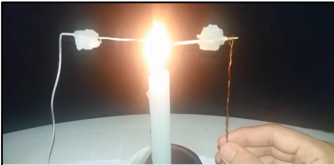
Figura 10 - Atividade experimental real sobre condução térmica.
