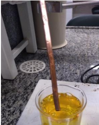
Figura 7 – Lâmina de cobre submersa no biodiesel
