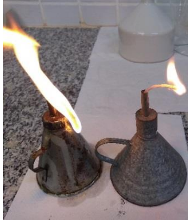
Figura 9 – Combustão do diesel e biodiesel
