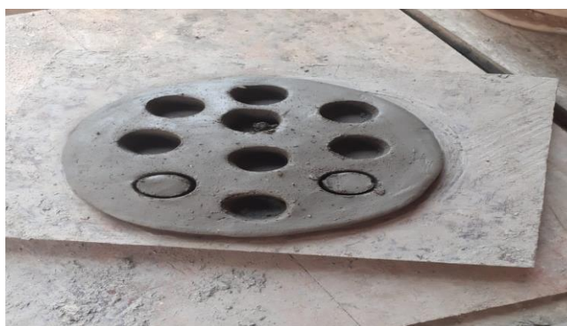
Figura 9 – Círculos sendo preparados para tampa de fogão.
