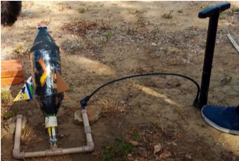
Figura 3 - Base de Lançamento
