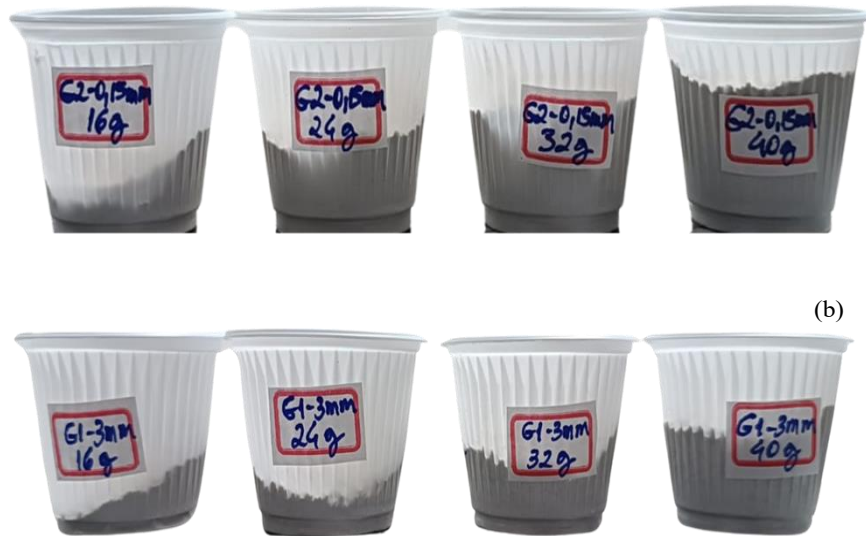
Figura 4 - Doses de pó de brita com granulometria 0,15 mm (a), e 3,00 mm (b). Porto Grande, Amapá, Brasil.
