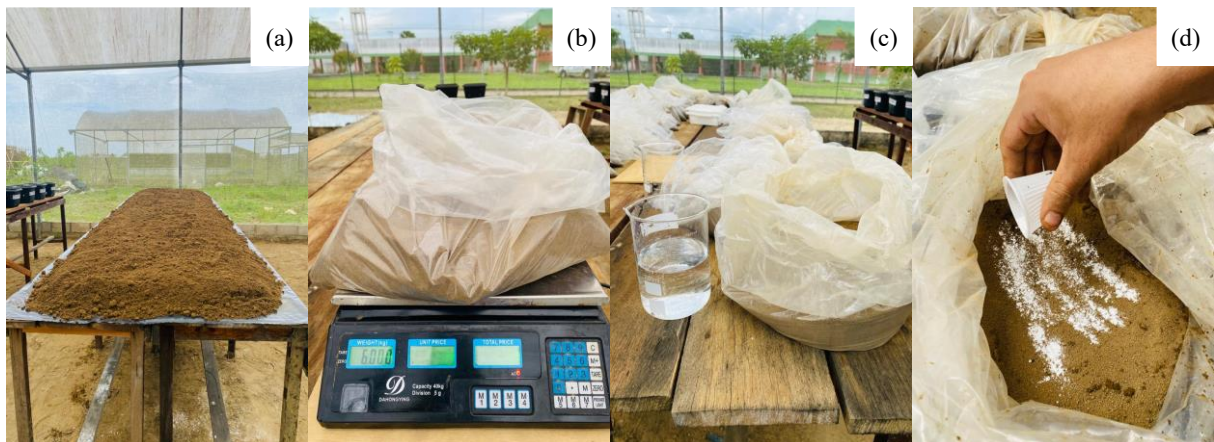
Figura 5 - Secagem do solo em casa de vegetação (a), pesagem do solo já peneirado (b), béquer com água equivalente ao volume de solo (c) e adição do calcário dolomítico (d). Porto Grande, Amapá, Brasil.
