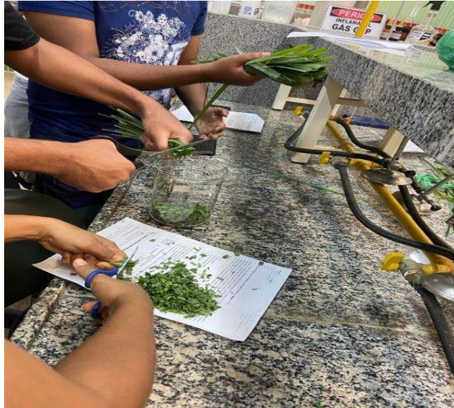
Figura 16 – Preparação de herbáceas para extração por arraste de vapor.
