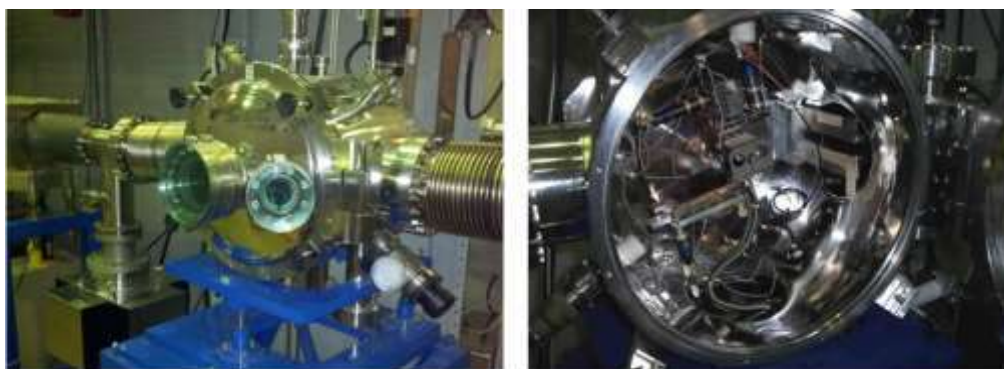
Figura 29 : Câmara do monocromador da linha XRD2. À esquerda: vista externa da câmara. À direita: vista interna [31].
