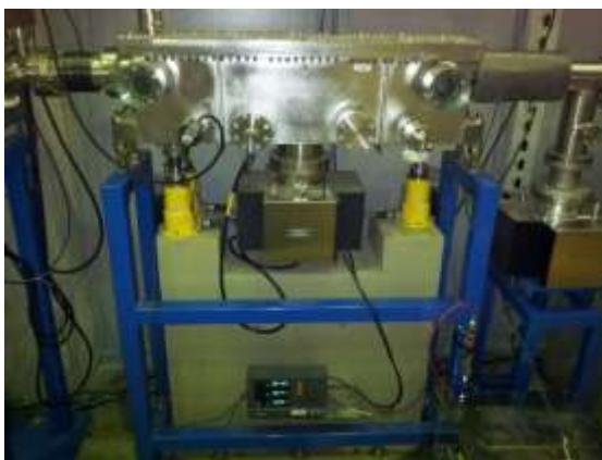
Figura 26: Câmara que acomoda o espelho da linha XRD2 [31].
