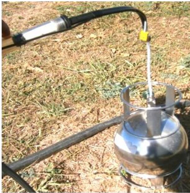
**Figura 3.4** - Canister para coleta das amostras gasosas.
