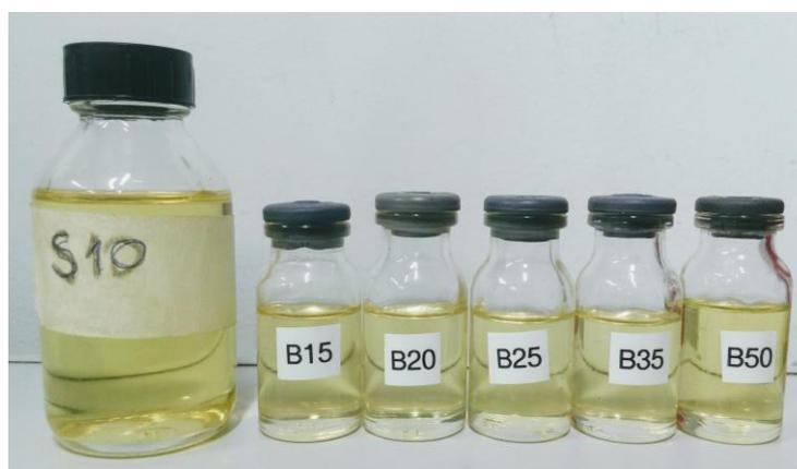
**Figura 3.1** - Amostras de blendas diesel/biodiesel de sebo bovino.
