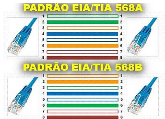
Figura 7 – Cabo de redes e os dois principais padrões.
