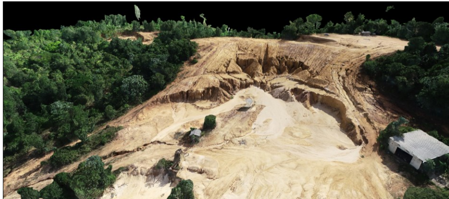
Figura 10 - Danos a topografia decorrente ao desmonte hidráulico e da precipitação.
