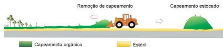
Figura 3 - Ilustração do decapeamento da camada fértil do solo e armazenamento.
