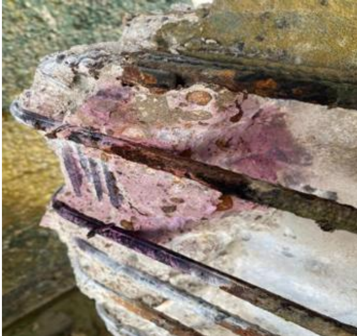
Figura 22- Ensaio de carbonatação
