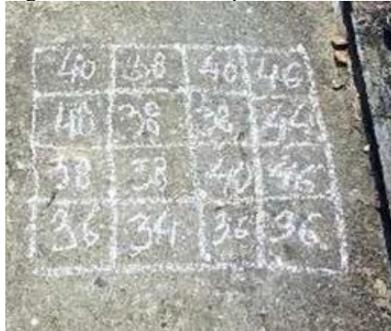
Figura 13 – Reticulado para ensaio de esclerometria
