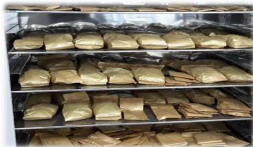
Figura 10 – Secagem de material vegetal em estufa de circulação forçada de ar.
