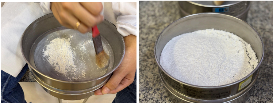
Figura 10 - Peneiramento a seco com auxílio de pincel de cerdas.
