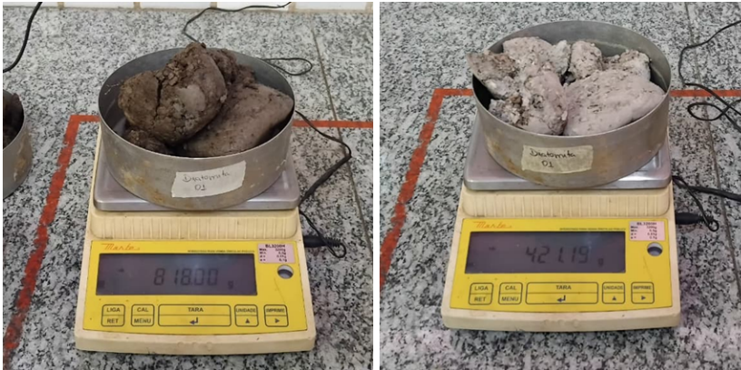
Figura 8 - Pesagem das amostras de diatomita in natura e secas a 105 °C.
