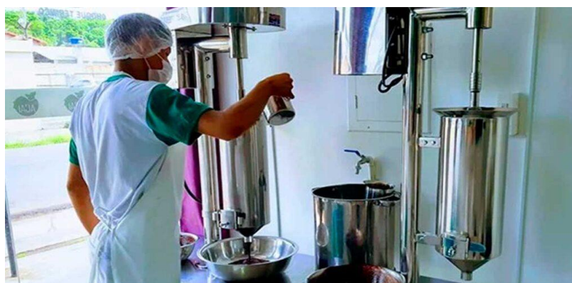
Figura 2 - Etapas do processamento artesanal do açaí: lavagem, hidratação, batimento e branqueamento dos frutos.
