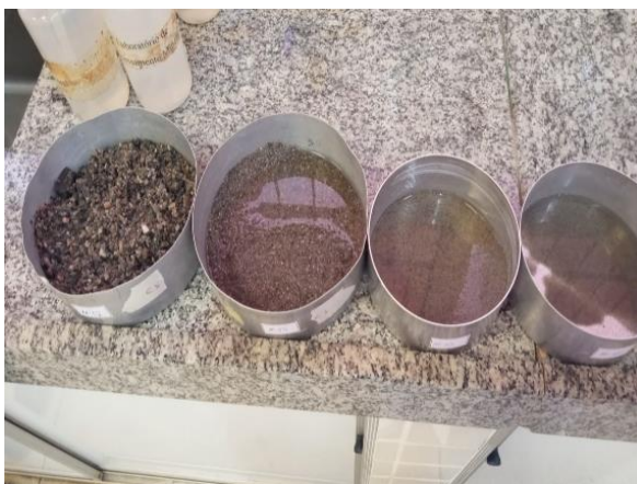
Figura 10 - (a) Amostra retida nas peneiras; (b) Amostras na estufa
