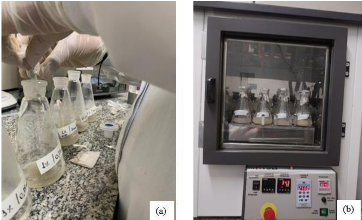
Figura 11 - (a) Adição da amostra no erlenmayer com a solução de ácido cítrico; (b) Ensaio de cinética de liberação na incubadora shaker
