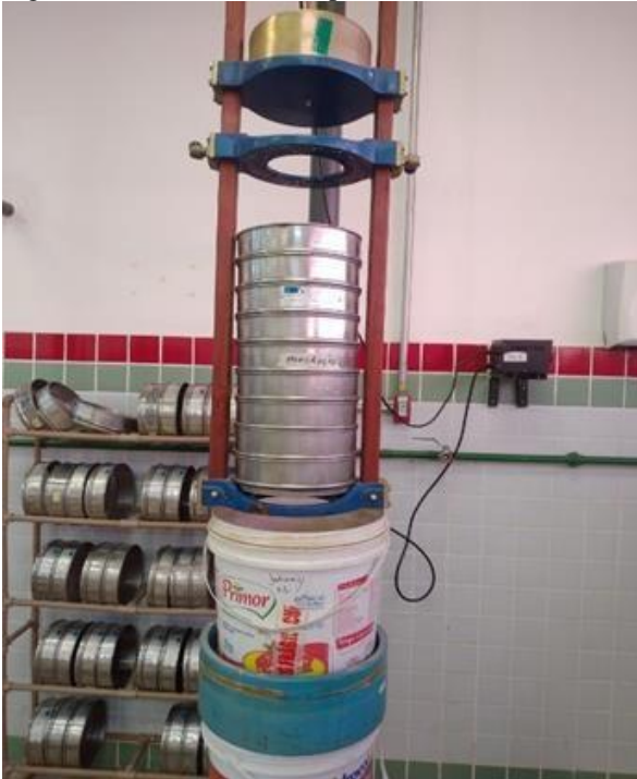
Figura 9 - Peneiramento suspenso via úmido.
