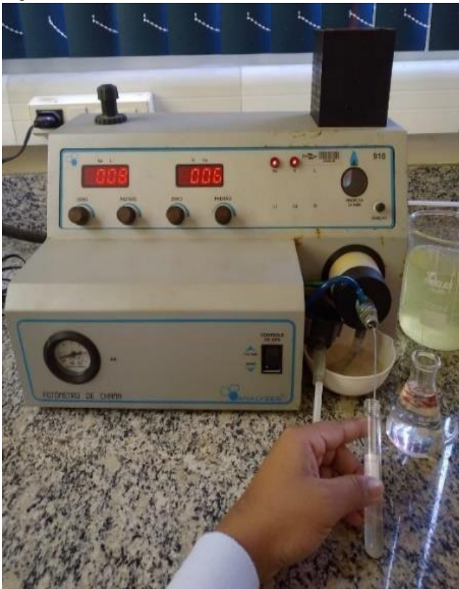
Figura 12 - Leitura das amostras no fotômetro de chama.
