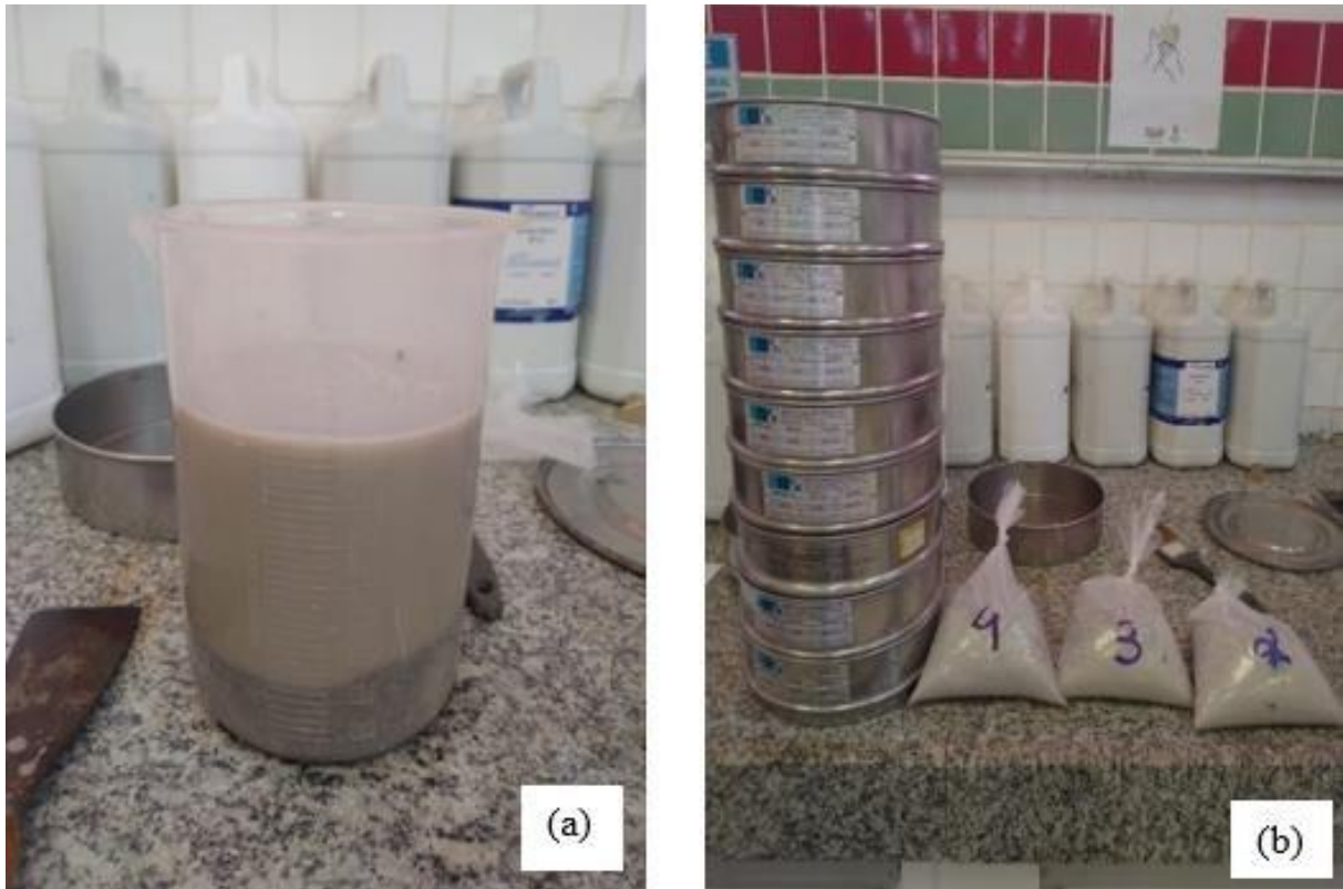
Figura 8 - (a) Polpa (água + alíquota de 1 kg); (b) Peneiras e amostras utilizadas
