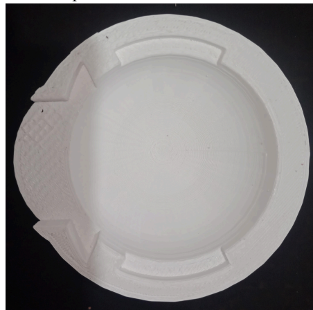
Figura 22 - Resultado da impressão do modelo 3D do olho humano sem defeito.
