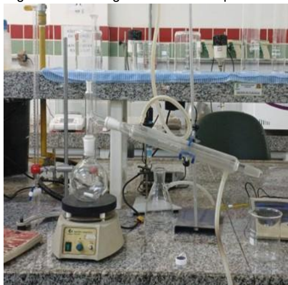
Figura 10 - Montagem das vidrarias para o ensaio de lixiviação
