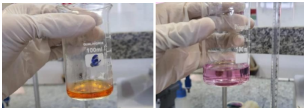
Figura 13 - Mudança de cor da solução após o ponto final.
