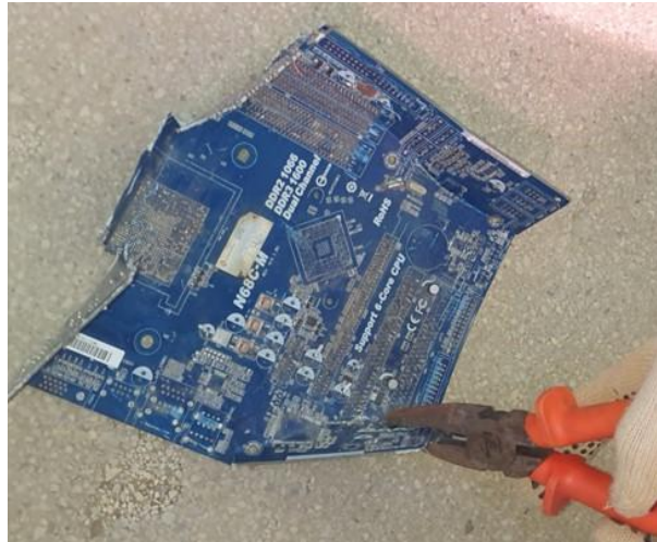
Figura 5 - Quebra manual das placas
