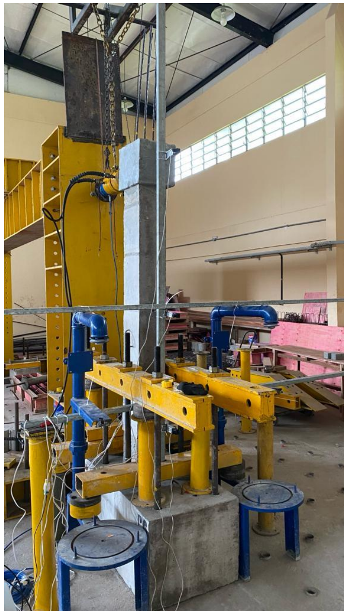
Figura 5.20– Fixação dos potenciômetros dos pilares P1/P2/P5/P6 (Fonte: Autor)
