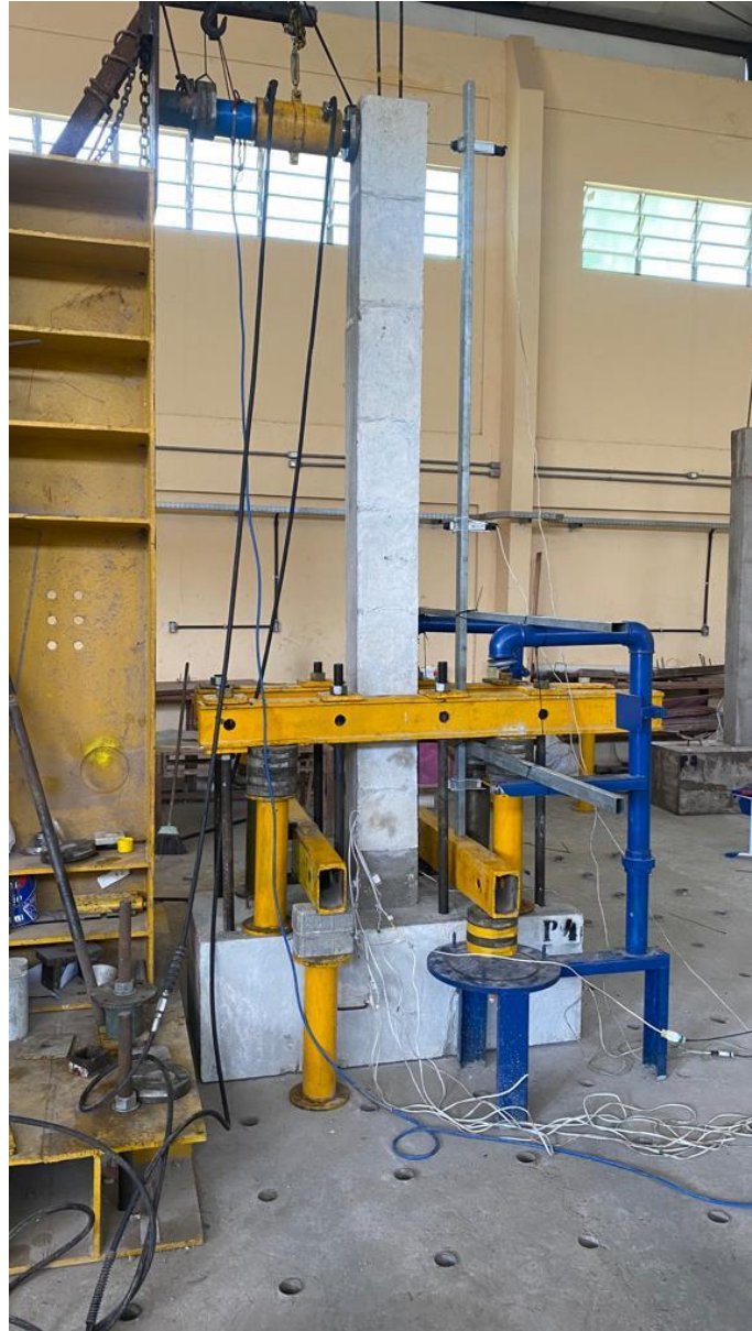
Figura 5.22 – Fixação dos potenciômetros do P4 (Fonte: Autor)
