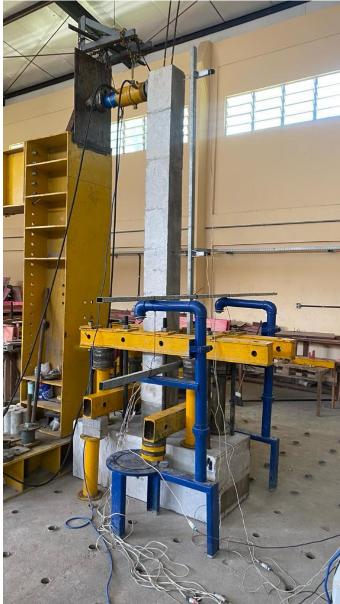
Figura 5.21 – Fixação dos potenciômetros do P3 (Fonte: Autor)
