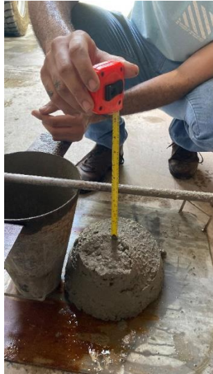
(a) Ensaio de abatimento
