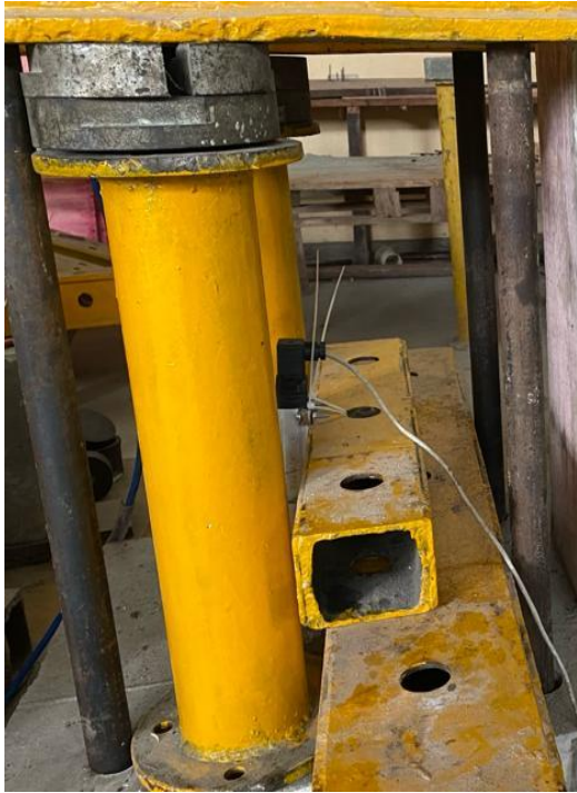
(a) Vigas de fixação de D4
