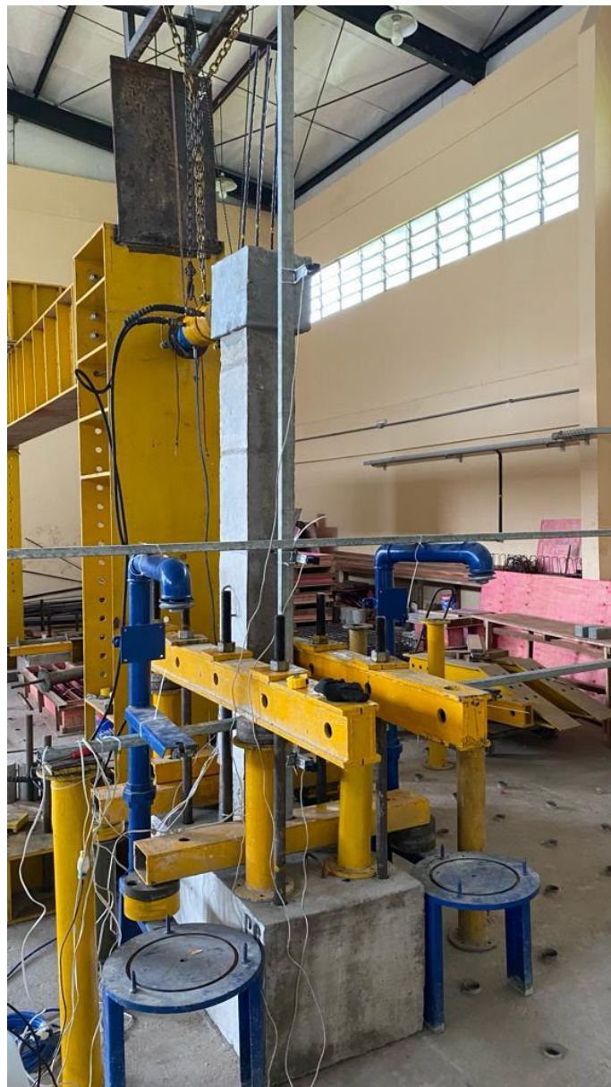
Figura 5.20– Fixação dos potenciômetros dos pilares P1/P2/P5/P6 (Fonte: Autor)
