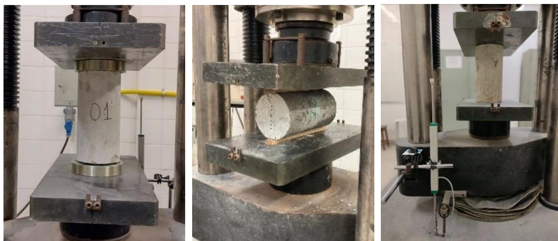
(a) Compressão axial (b) Compressão diametral (c) Módulo de elasticidade
