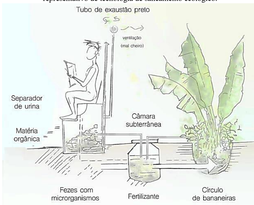
Figura 8 – Esquema funcional de um banheiro seco com câmara de compostagem e fluxo de nutrientes, representativo de tecnologia de saneamento ecológico.
