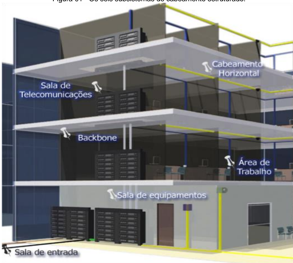
Figura 01 - Os seis subsistemas de cabeamento estruturado.
