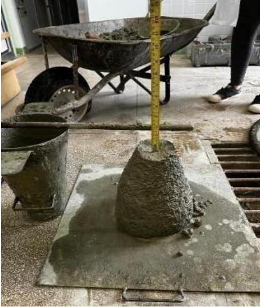
Figura 5 – Aspecto do concreto dosado sem fibra de aço.
