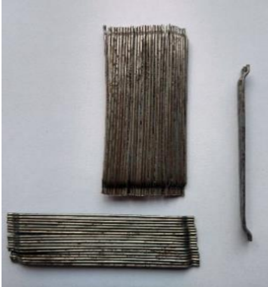
Figura 7 – Aspecto das fibras de aço utilizadas.
