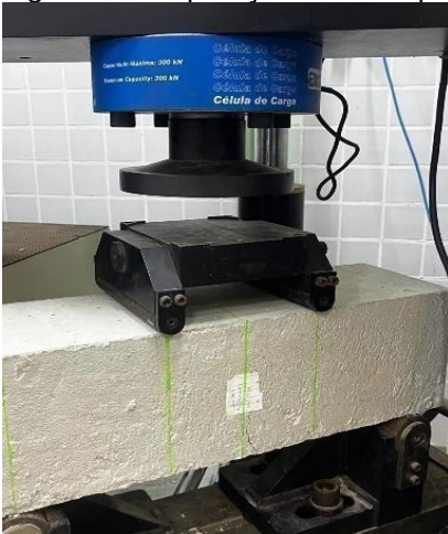
Figura 4 – Preparação dos CPs prismáticos para ruptura.
