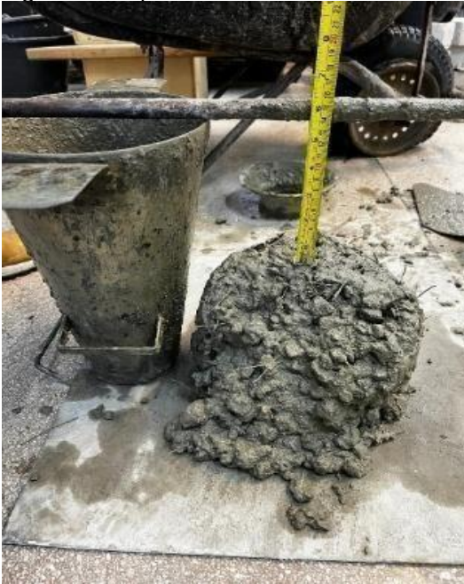
Figura 6 – Aspecto do concreto dosado com fibra de aço.
