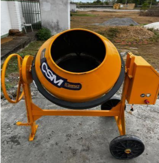
Figura 8 – Betoneira utilizada na produção dos traços de concreto.
