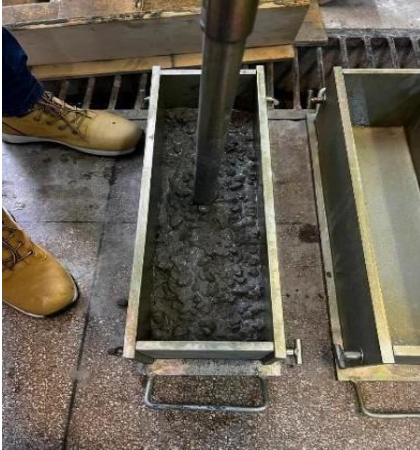
Figura 3 – Confeção dos CPS prismáticos.
