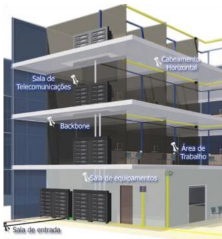
Figura 1 - Subsistemas do Cabeamento Estruturado
