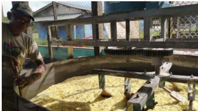
Figura 17 - Forno mecanizado utilizado na Comunidade Quilombola do Curralinho
