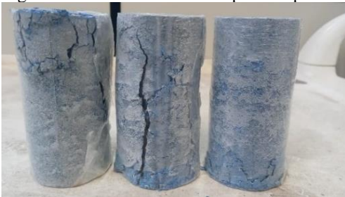
Figura 8 - CP's de referência após rompimento.
