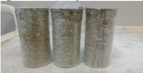
Figura 9 - CP's com adição de CCA a 500°C após rompimento.
