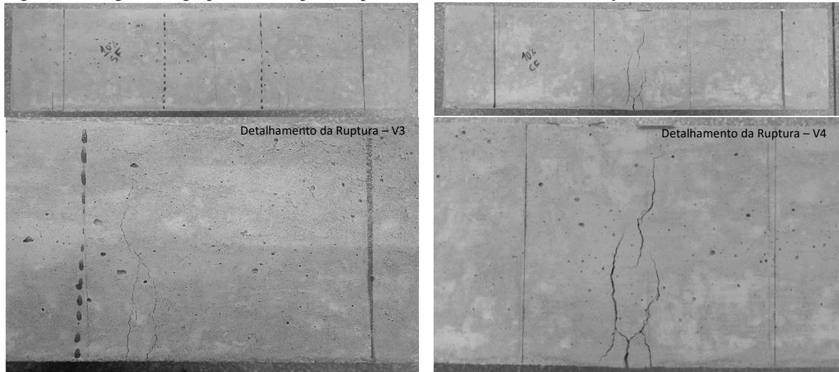
(a) V3 após ensaio com ruptura (fissura) à direita
