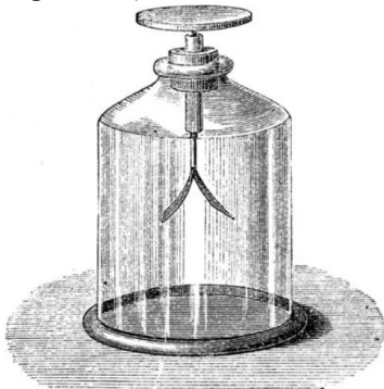
Figura 3 - Eletroscópio de folha de ouro. De Silvanus P. Thompson, Lições elementares em electricity e magnetism (New York: Millan, 1901), 16.
