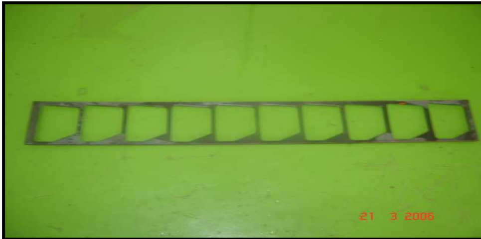
Figura 17 - Tira da chapa após o corte das peças no processo proposto
