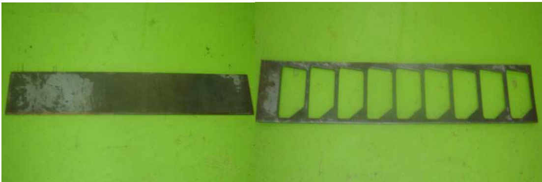
Figura 16 - Tira de chapa antes e após o corte das peças (processo atual)
