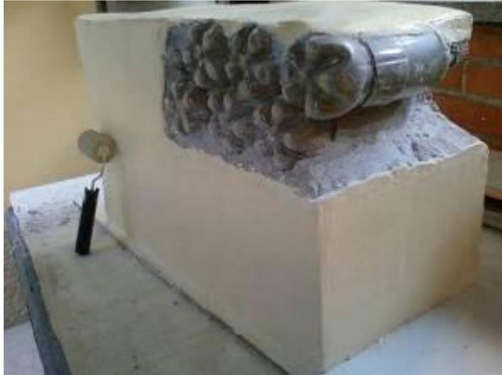
Figura 7 - Vista lateral do bloco utilizando garrafas PET (Galli *et al.*,2014)
