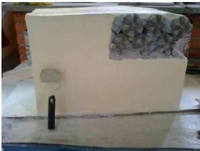
Figura 6 - Vista frontal do bloco utilizando garrafas PET (Galli *et al.*,2014)
