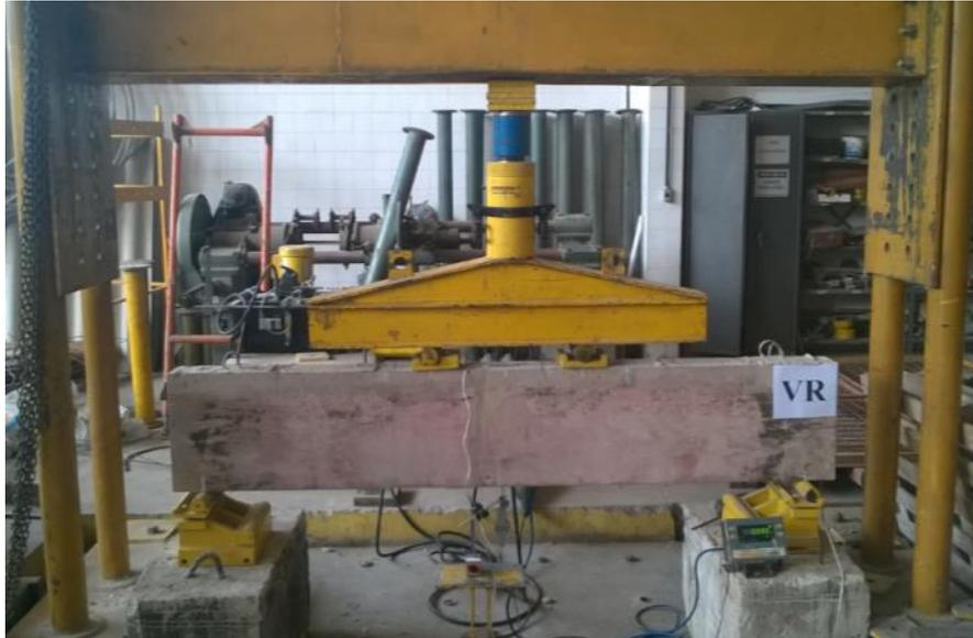
Figura 36 - Viga VR no sistema de ensaio
