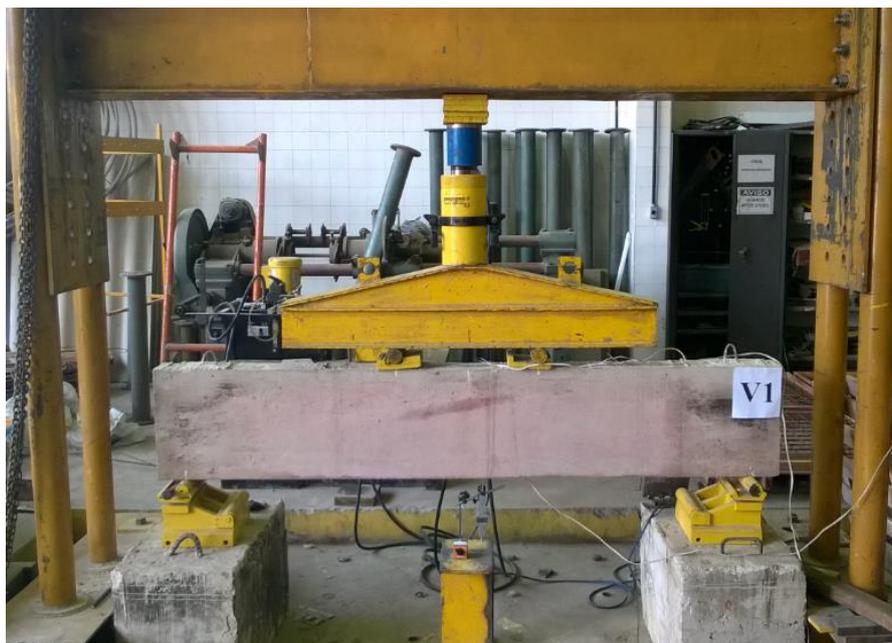
Figura 37 - Viga V1 no sistema de ensaio
