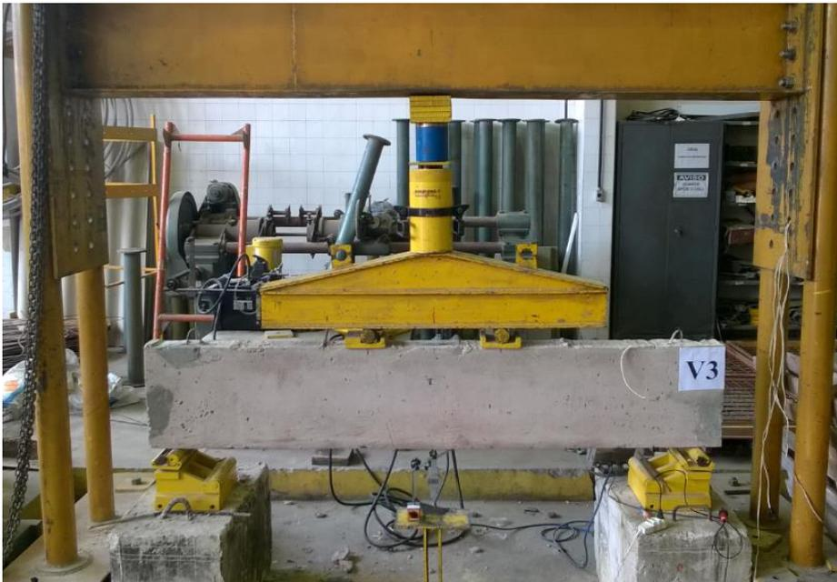
Figura 39 - Viga V3 no sistema de ensaio
