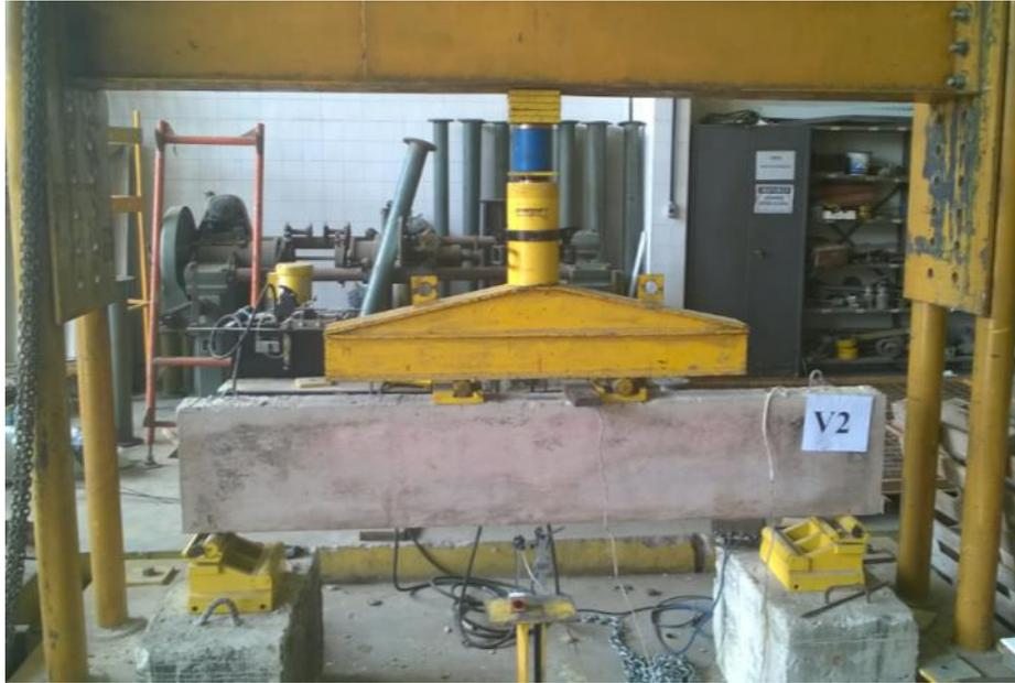
Figura 38 - Viga V2 no sistema de ensaio
