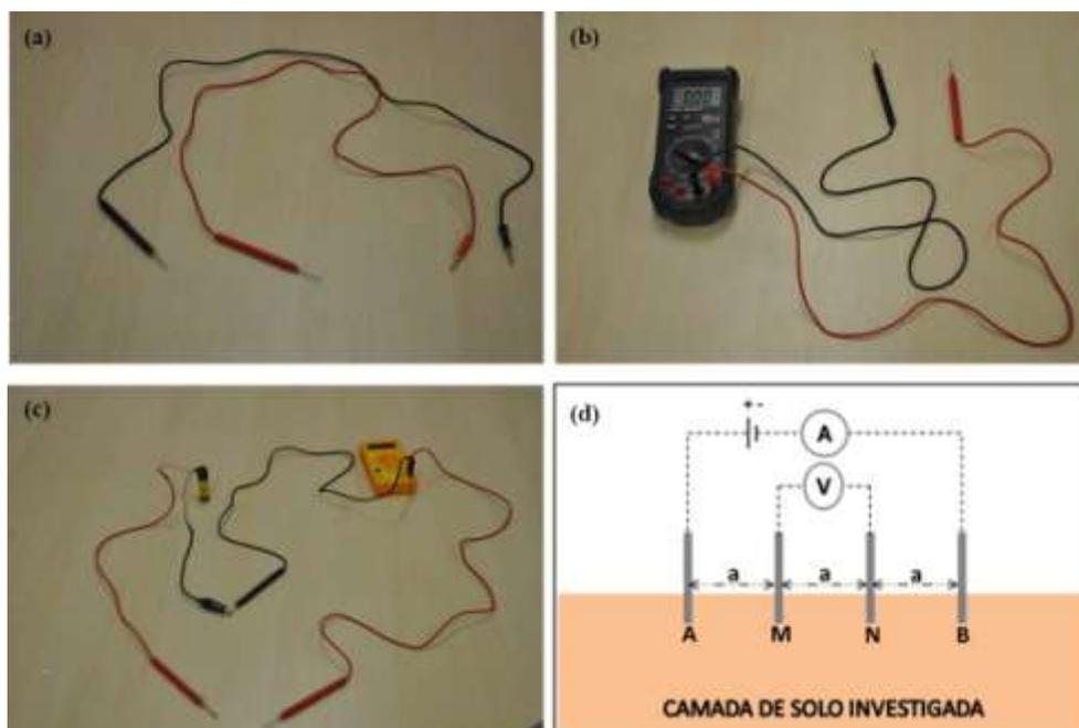
**Figura 9 - (a) pontas de provas com conexão para multímetros conforme descrito na figura 7; (b) conexão do item (a) ao multímetro que medirá d.d.p; (c) associação em série entre bateria e multímetro para que se meça a corrente elétrica; (d) configuração elétrica do experimento, sendo A representação do amperímetro (multímetro amarelo) e V a representação do voltímetro (multímetro escuro).**
