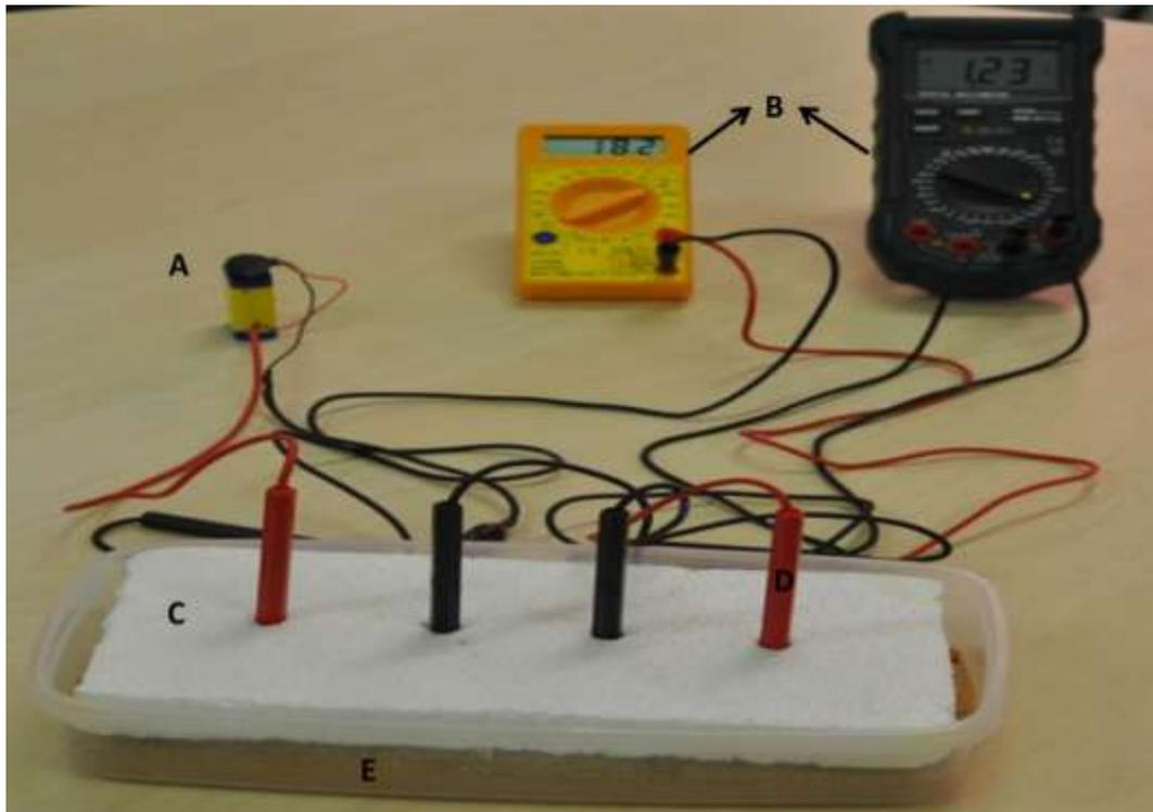
**Figura 7 - Experimento montado, sendo: (A) – bateria de 9V; (B) – multímetros; (C) – uma base de isopor para dar sustentação aos eletrodos; (D) – eletrodos feitos a partir das pontas de prova do multímetro; (E) recipiente de plástico contendo amostra de solo.**
