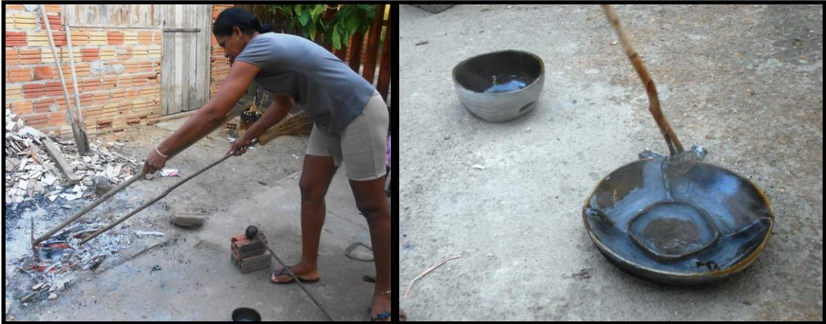
Figura 04: Louceira retira as peças da queima e depois impermeabiliza com resina vegetal.
