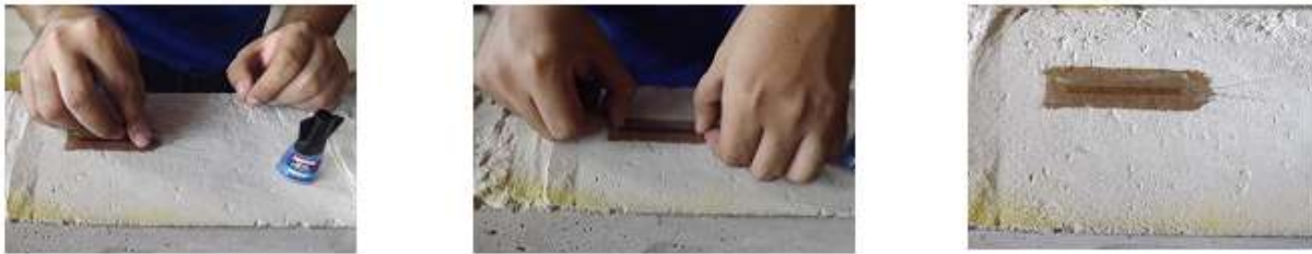
Figura 99 - Fixação dos extensômetros na região comprimida
