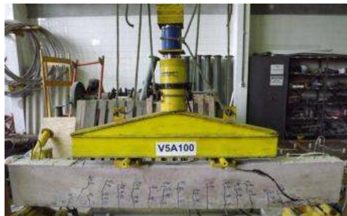
Figura 111 - Fissuras na viga V5A100 após ruptura de cisalhamento, por tração
