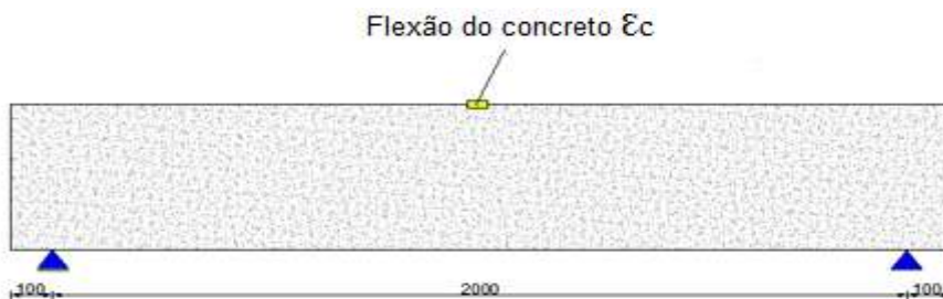
Figura 98 - Posição do extensômetro na região comprimida da viga
