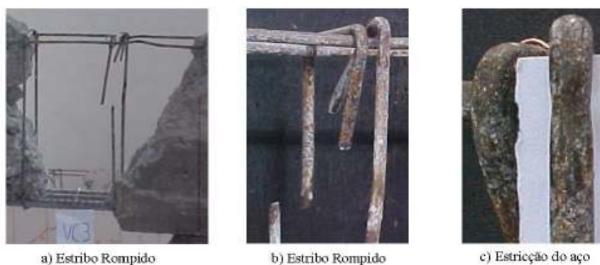
Figura 70 - Ruptura dos estribos convencionais (CARELLI, 2002).
