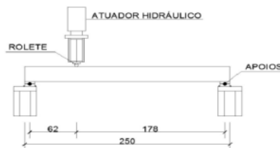
Figura 59 - Esquema de ensaio. (SILVA, 2012)
