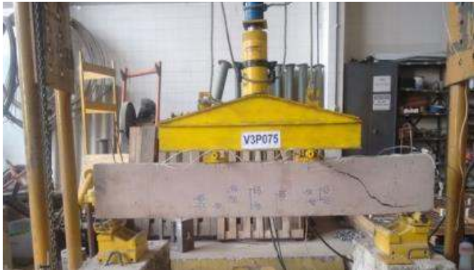
Figura 107 - Fissuras na viga V3P075 após ruptura de cisalhamento, por tração
