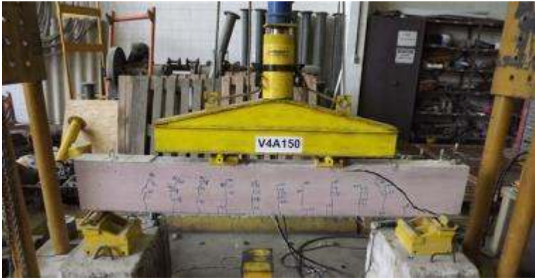
Figura 109- Fissuras na viga V4A150 após ruptura de cisalhamento, por tração
