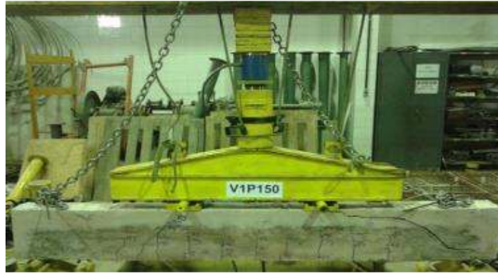
Figura 103 - Fissuras na viga V1P150 após ruptura de cisalhamento, por tração
