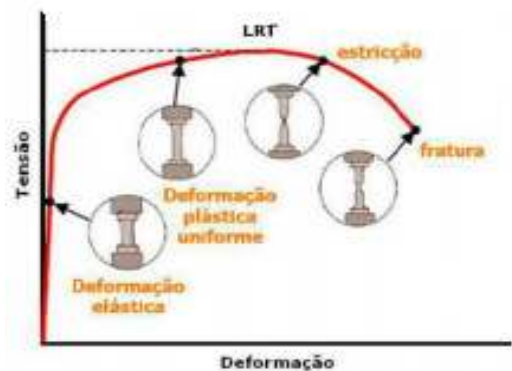
Figura 15 - Perfil da amostra de metais com a estrição em vários estágios de deformação (CALLISTER, 2002)
