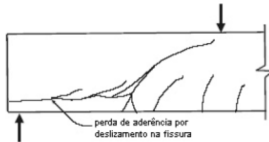
Figura 36 - Ruptura por escorregamento das barras longitudinais tracionadas. (ACI-ASCE 426, 1973).
