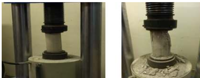
Figura 85 - Corpo-de-prova em ensaio de compressão
