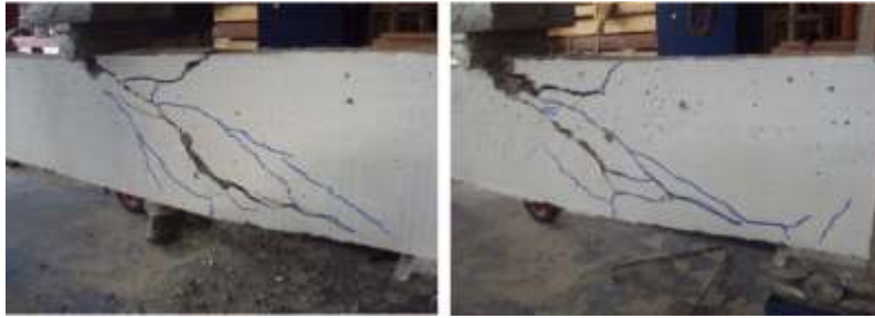
Figura 61 - Ensaio da viga VC e VC02 (SILVA, 2012)
