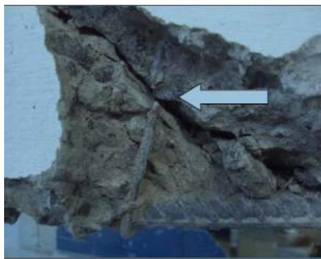
Figura 62 - posição da ruptura dos estribos contínuos (SILVA, 2012)
