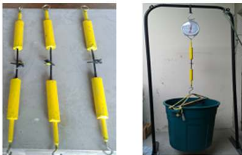
Figura 90 – preparo dos estribos plásticos para o ensaio preliminar
