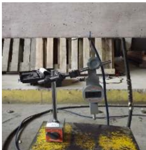
Figura 94 - Detalhe da posição do deflectômetro digital sob a viga.
