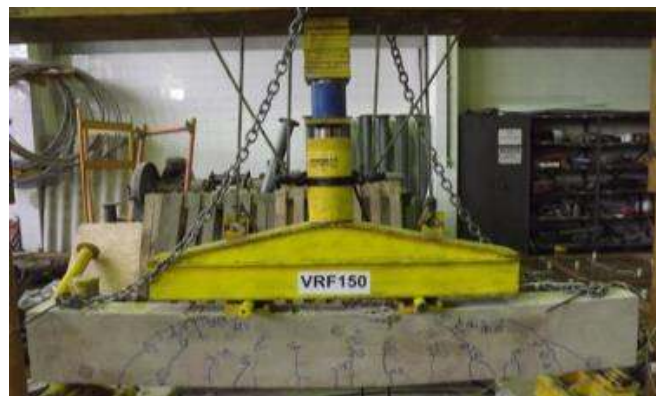
Figura 101 - Fissuras na viga VRF150 após a ruptura por flexão com esmagamento do concreto na região comprimida
