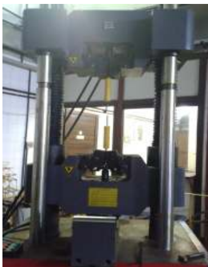
Figura 91 - Ensaio das amostras dos estribos plástico
