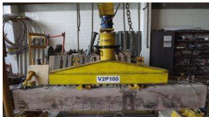
Figura 105 - Fissuras na viga V2P100 após ruptura de cisalhamento, por tração
